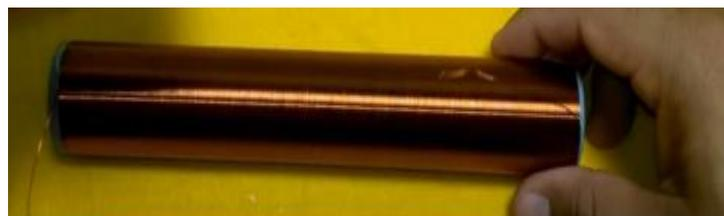
Recordemos que se debe de ver que el alambre cobre no se encime con el que ya enrollaste anteriormente, pues se dieron de 500 a 600 vueltas.
